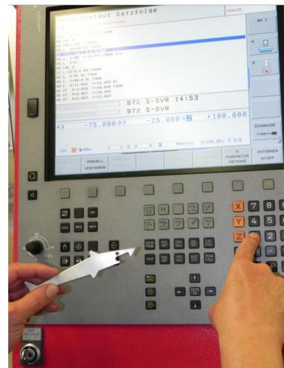
Durch die Bearbeitung entstehen scharfe Kanten. Diese werden nun mit einer Klinge entgratet.
