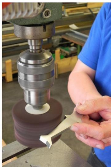
Danach wird der Flaschenhai gebürstet. Man lässt den Hai über ein Schleifvlies gleiten, so dass auf der Oberfläche ein Schliffbild entsteht.
